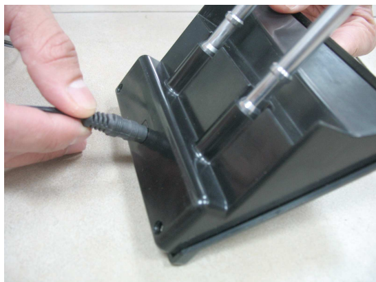
Bild 3.1 Anschließen des Standardnetzteils an den Ladeadapter.
