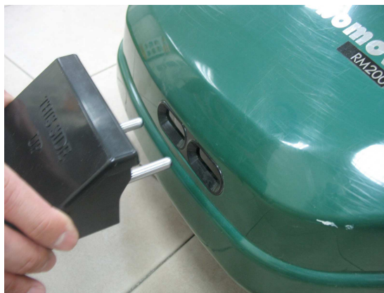
Bild 3.2 Anschließen des Ladeadapters an den Robomow
