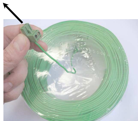
Bild 1.12 – Ziehen Sie den Draht aus der Plastikhülle. Entfernen Sie die Hülle nicht - sie ist als Kabelspender gedacht.
