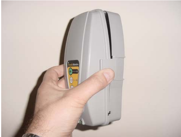
Abbildung 1.31 – Deckel zusammendrücken zum entfernen.
