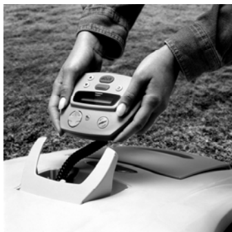
Die manuelle Steuerung wegnehmen und für den manuellen Betrieb benützen
