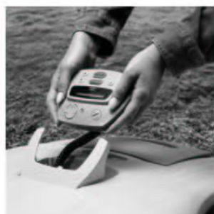
Abbildung 3.9 – Die manuelle Steuerung aus ihrem Halter wegnehmen
