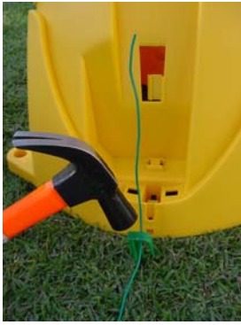
Abbildung 1.8 – Mit dem Begrenzungsdraht anfangen in einer Zone mit Ladestation
