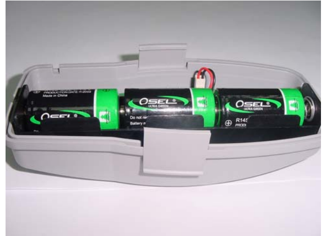
Abbildung 1.32 C. Batterien in Halterung einsetzen.
