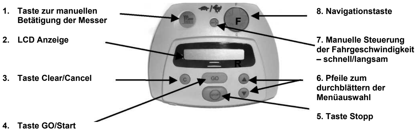
Abbildung 2.3 – Layout der manuellen Steuerung
