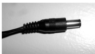
Ausgang Kabel des Stromversorgers
