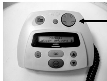
"Navigator" Taste bei der manuellen Steuerung
