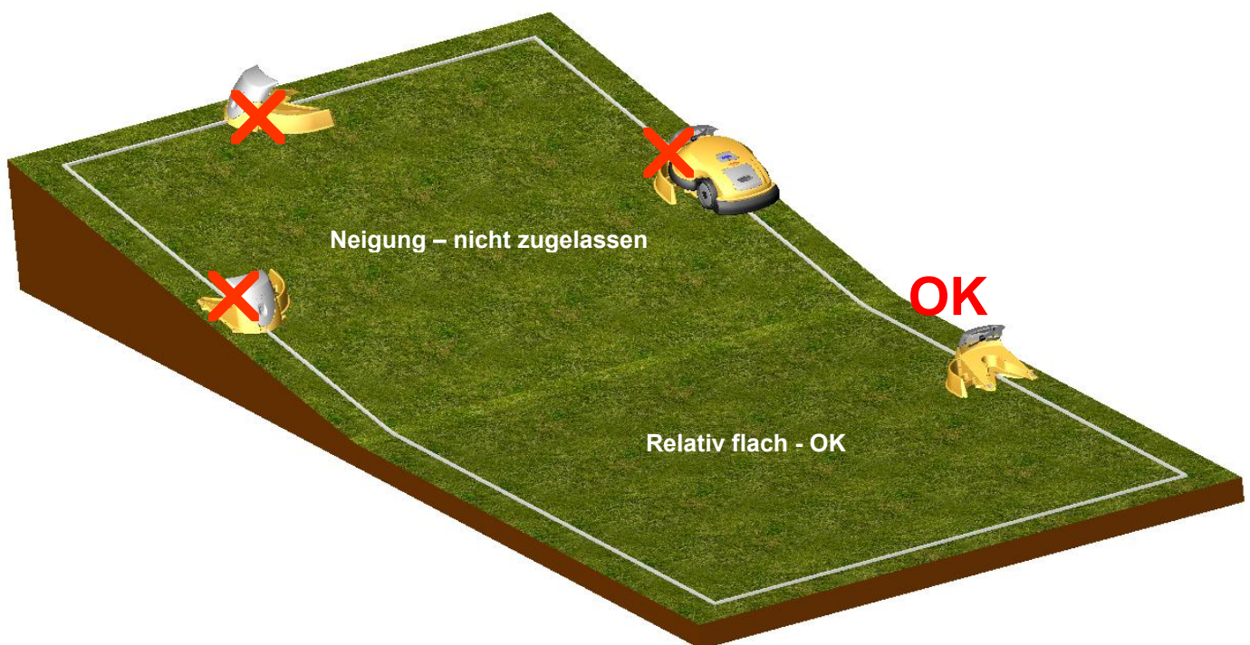
Abbildung 1.6 - Die Ladestation auf ebenen Boden installieren
