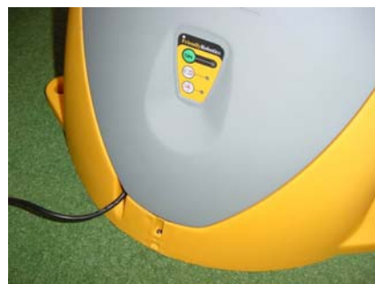
Abbildung 1.21 – Gute Lage des Stromversorgungsdrahtes
