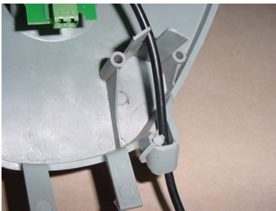
Abbildung 1.18 Stromversorgungsdraht im Deckel legen
