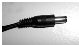
Ausgang Kabel des Stromversorgers
