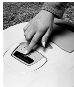
Halter der manuellen Steuerung zurückgekippt und in einer Linie mit der Haube
